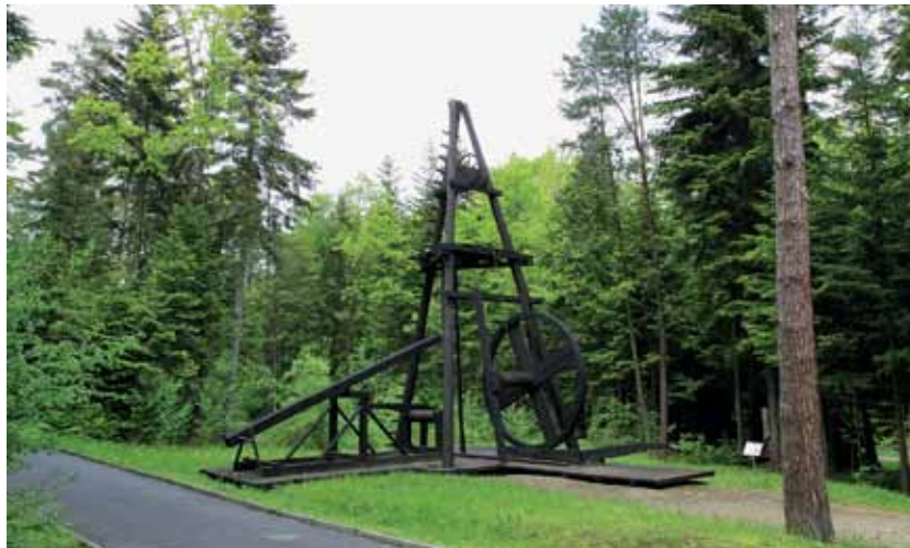
Zrekonstruowane ręczne urządzenie wiertnicze z 1862 r.
