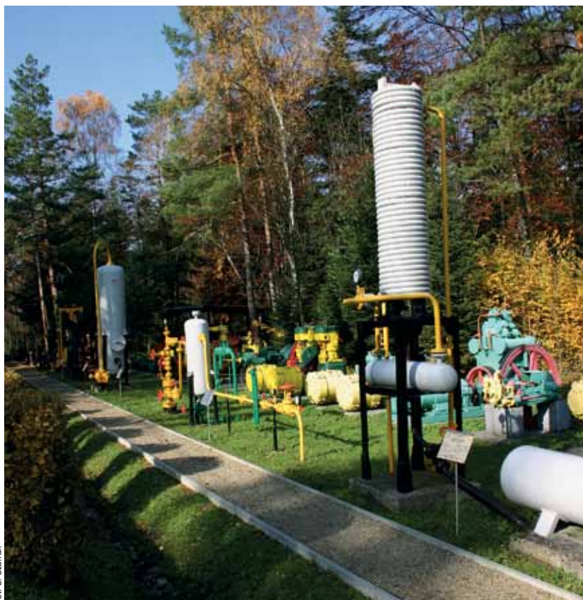
Napowierzchniowe wyposażenie odwiertów do eksploatacji gazu ziemnego
