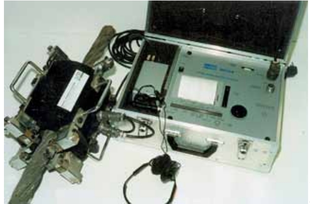
Rys. 18. Głowica GM-60 (produkcji AGH-KTL) z defektografem MD-120 produkcji NDT Zawada
