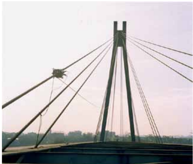
Rys. 28. Badania magnetyczne lin nośnych mostu wiszącego
