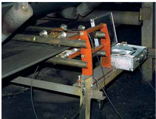
Rys. 29. Badania magnetyczne lin taśm przenośnikowych z linkami stalowymi
