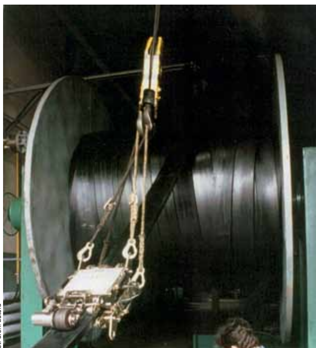
Rys. 24. Odbiorcze badania magnetyczne nowej liny stalowo-gumowej
