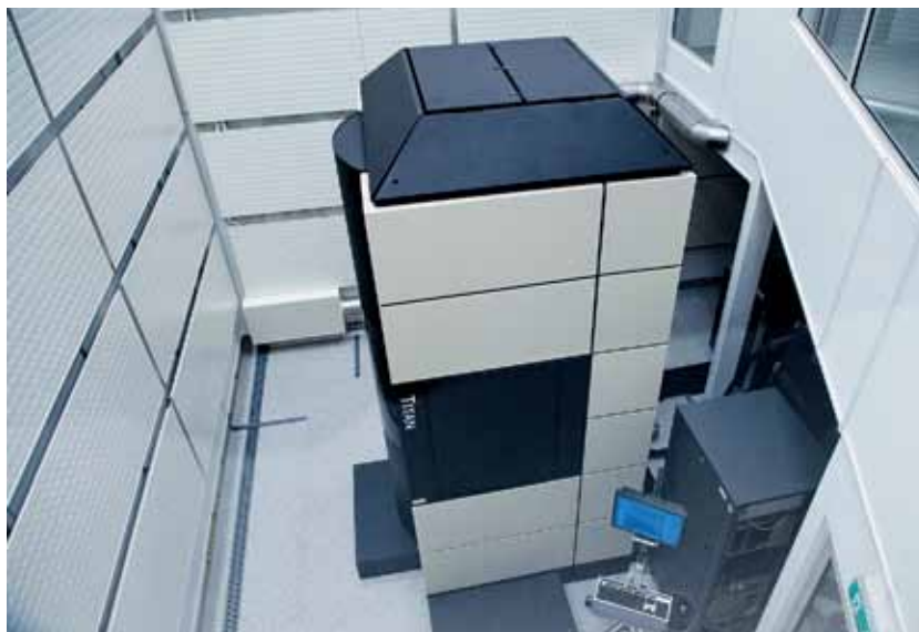
Analityczny wysokorozdzielczy transmisyjny mikroskop elektronowy 3S/TEM FEI Titan G2 60-300
