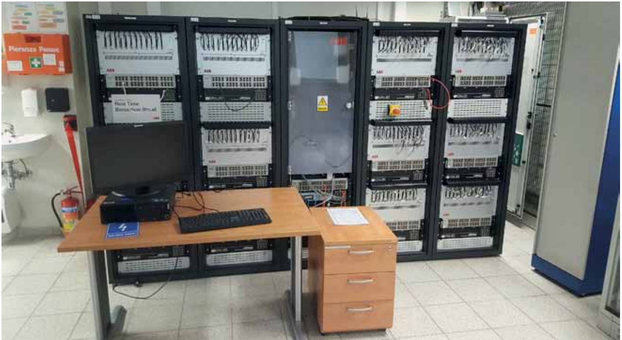
Wysokowydajny symulator pracujący w czasie rzeczywistym – laboratorium zbudowane wspólnie z ABB
