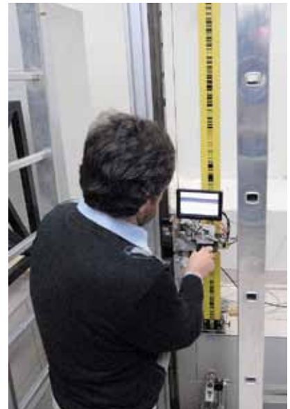
Porównanie łąty precyzyjnej za pomocą systemu interferometrycznego
