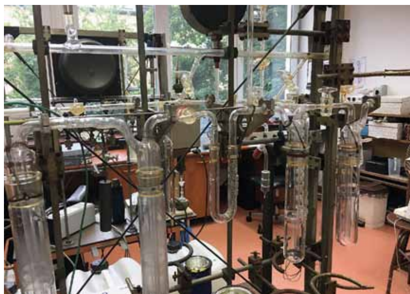
Układ do ekstrakcji CO 2 z wody, Laboratorium Pomiarów Niskich Aktywności
