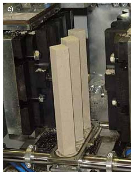
Rys. 6. Hala maszyn Wydziału Odlewnictwa; a) widok regeneratora REGMAS, b) Widok stanowiska nadmuchiarki LUT/c/CO 2 /An oraz c) wykonywanych rdzeni – próbki do badania wytrzymałości na zginanie R m
