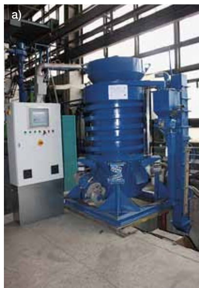
Rys. 6. Hala maszyn Wydziału Odlewnictwa; a) widok regeneratora REGMAS, b) Widok stanowiska nadmuchiarki LUT/c/CO 2 /An oraz c) wykonywanych rdzeni – próbki do badania wytrzymałości na zginanie R m
