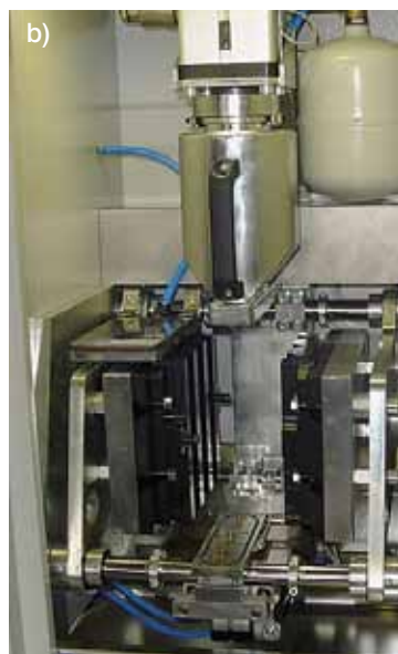
Rys. 6. Hala maszyn Wydziału Odlewnictwa; a) widok regeneratora REGMAS, b) Widok stanowiska nadmuchiarki LUT/c/CO 2 /An oraz c) wykonywanych rdzeni – próbki do badania wytrzymałości na zginanie R m
