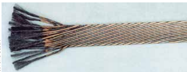
Kabel uzwojenia elektromagnesów nadprzewodnikowych.
