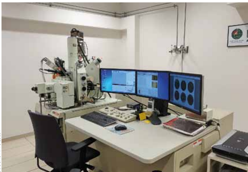
Laboratorium Pierwiałków Krytycznych – mikroanalizator rentgenowski
