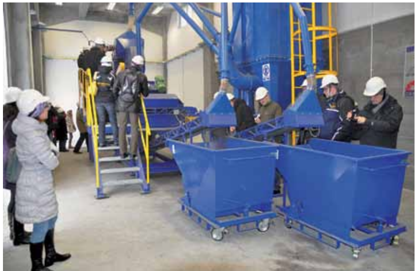
Demonstracja instalacji do produkcji kruszyw z odpadów powęglowych w Centralnym Laboratorium Techniki Strzelniczej i Materiałów Wybuchowych AGH w Regulicach
