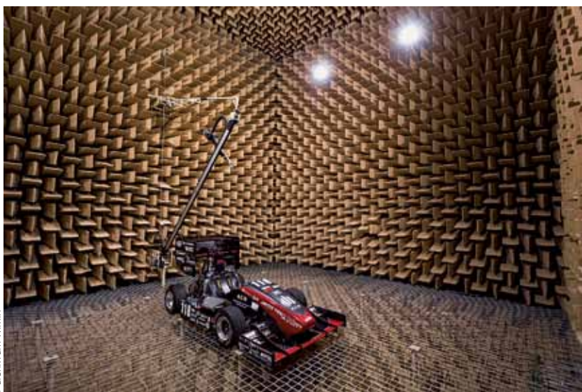
Laboratorium akustyki technicznej – bolid formuły student (konstrukcja AGH Racing) w komorze bezchowej
