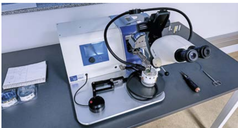
Bonder typu HB05 z mikroskopem optycznym i stolikiem grzejmym. Akademyckie Centrum Materiałów i Nanotechnologii
