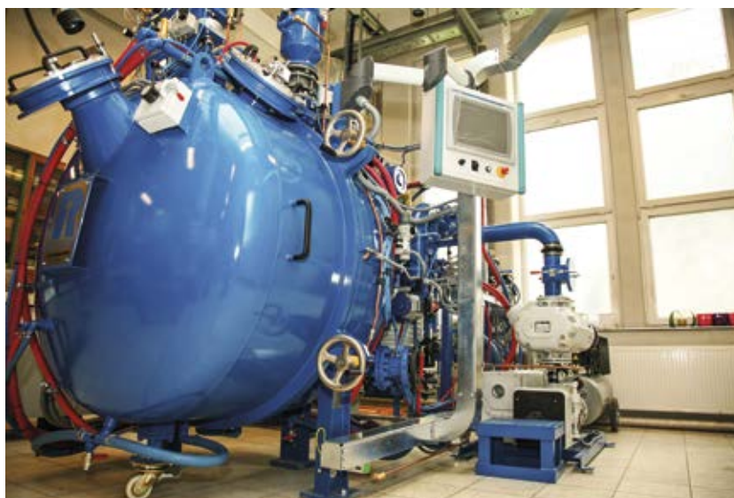
Indukcyjny piec próżniowy do wytapiania stali i stopów metali oraz ich odlewania w kontrolowanej atmosferze, typ VIM LAB 20 – 50. Wydział Inżynierii Metali i Informatyki Przemysłowe
