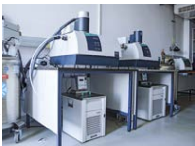
Zestaw do pomiaru dyfuzyjności cieplnej metodą LFA i ciepła właściwego oraz przemian fazowych metodą DSC. Katedra Podstawowych Problemów Energetyki
