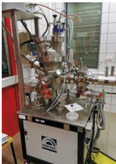
Komora próżniowa z magnetronami DC i RF oraz źródłem jonów KDC40 – System do trawienia i nanoszenia warstw z wyposażeniem. Instytut Elektroniki
