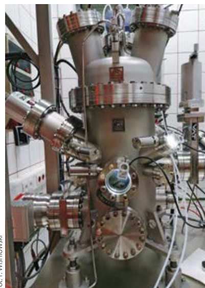
Komora próżniowa z magnetronami DC i RF oraz źródłem jonów KDC40 – System do trawienia i nanoszenia warstw z wyposażeniem. Instytut Elektroniki
